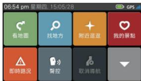
4. 程式開啟後，系統即自動開始定位。首次衛星定位請停留在同一地點，以較空曠之處為宜，上方不得有遮蔽物。依據您所在位置不同，等候定位完成可能需要 10 分鐘以上。一般至少要接收 4 顆衛星的訊號，才能夠完成 GPS 定位。
